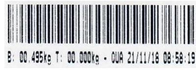
Figura 33 – Protocolo EPL, impressão Peso e Tara (dimensões aproximadas 65x25mm)
