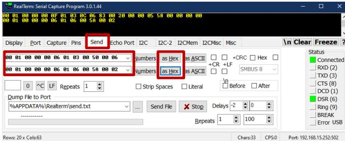
Figura 31 – Comando de leitura de peso e status, comando remoto de tara via RealTerm
