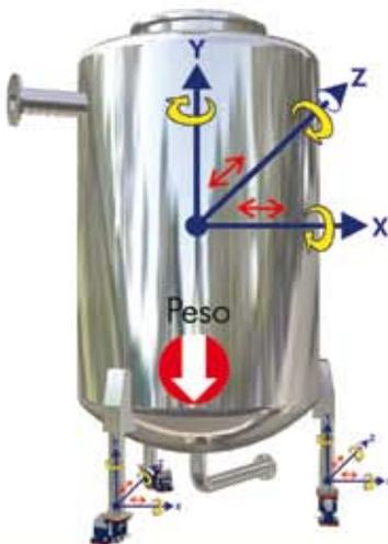
mantendo sempre a Célula de Carga paralelo ao solo. Como a gravidade age na vertical o peso estará sempre perpendicular à Célula de Carga.
